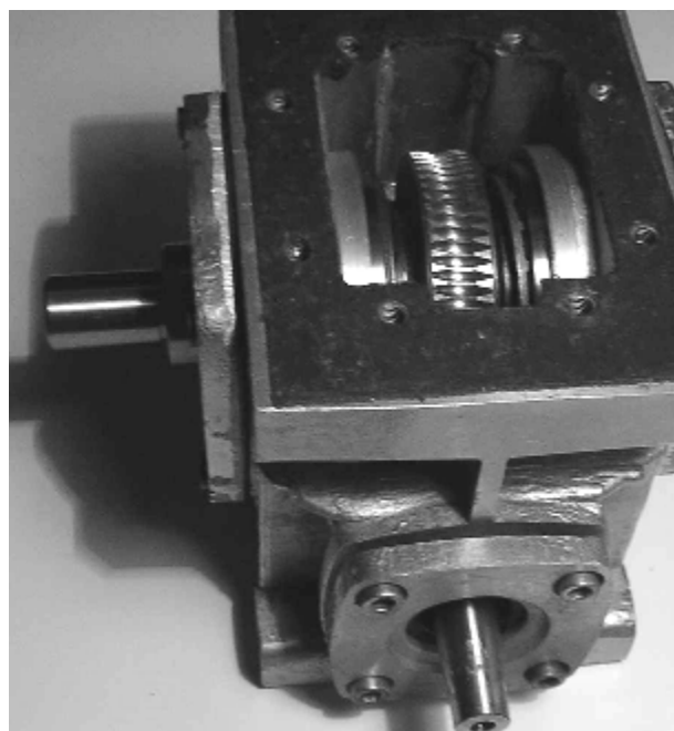
Рис.5. Виготовлена черв'ячна передача в корпусі редуктора 2Ч40
