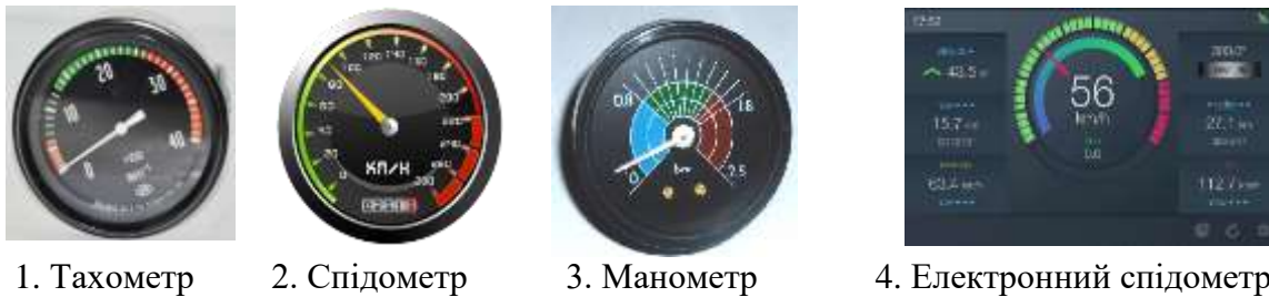
Рис. 1. Використання кольору для позначення небезпечної та безпечної роботи систем і механізмів в приладах: 1. Тахометр. 2. Спідометр. 3. Манометр. 4. Електронний спідометр.
